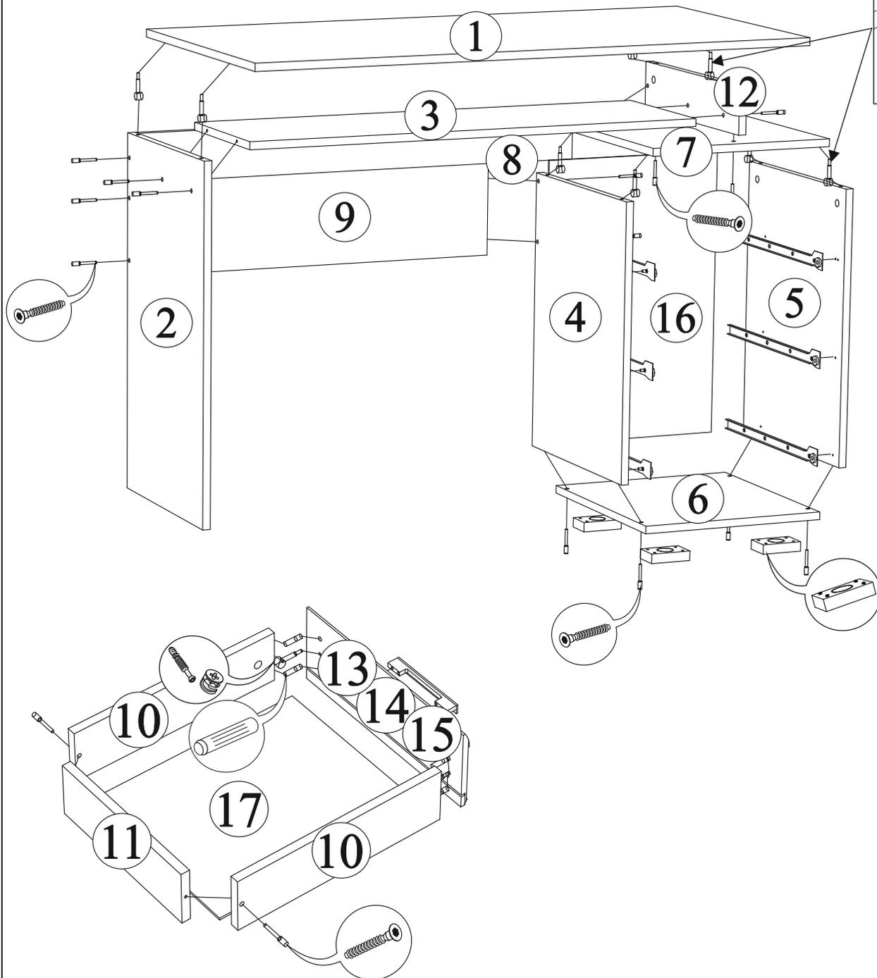
Для правильного открывания фасадов, необходимо выровнять диагонали каркаса (Рис.1) и только потом прибить ЛДВП не нарушая диагонали.
